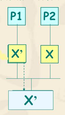
若P1采用"写 通过"策略,即处 理机改写Cache中 的数据时同时修改 内存中相应的数据, 那么,内存中的X 也同时变为X',但 是,处理机P2的本 地高速缓冲存储器 C2中的X仍然是X。
